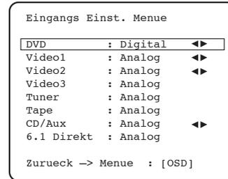
Für Analogeingänge ist ein Stereo-Phono/RCA auf Phono/RCA-Kabel zur Verbindung mit dem 540R v3 erforderlich. Für digitale Eingänge benötigen Sie entweder ein digitales Koaxialkabel Phono/RCA auf Phono/RCA (SPDIF) mit 75Ohm, oder ein Glasfaserkabel (TOSLINK). Der 540R v3 erkennt automatisch das angeschlossene Kabel. Bitte stellen Sie für die Eingangsquellen keine doppelte Verbindung (optischer und koaxialer Eingangs) her.
