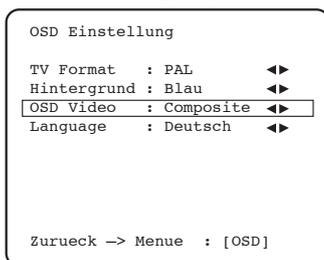
Das OSD-Menü wird entweder auf einem blauen Hintergrund angezeigt, oder dem analogen Videobild überlagert. Wählen Sie "Hintergrund" und benutzen Sie die Pfeiltasten (links/rechts), um zwischen 'Blau' und 'Video' als Hintergrund zu wählen.
