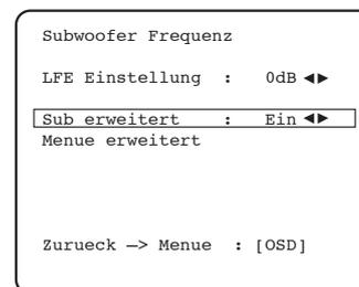
Bei nunmehr eingeschalteter erweiterter Basskontrolle verschwindet der Eintrag 'Sub Crossover' und der neue Eintrag 'Menü erweitert' wird angezeigt. Um Änderungen an den erweiterten Einstellungen vorzunehmen, rufen Sie 'Menü erweitert' auf und drücken Sie "Enter":
