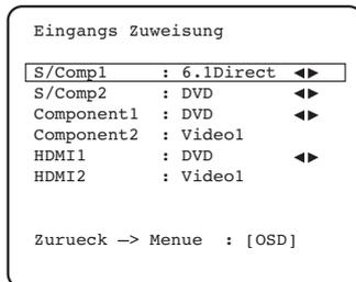
**Hinweis:** Der 540R v3 verhindert, dass zwei Gerätequellen demselben Videoeingang zugewiesen werden, da hierdurch Probleme entstehen könnten. Allerdings lässt sich dieselbe Gerätequelle verschiedenen Videoeingängen zuweisen.
