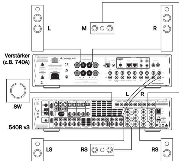
Setzen Sie die 'Preamp Out' Einstellung im OSD-Menü auf 'Ext2Ch', um nur die Lautsprecherausgänge vorne links/rechts stumm zu schalten:
