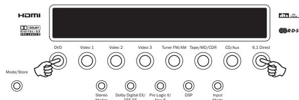
Auf dem Frontpanel wird kurzzeitig "RESET" erscheinen, bevor der Standby-Modus eingeschaltet wird.
