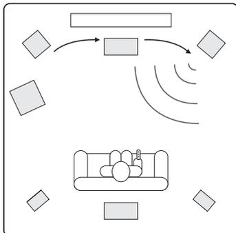
Justieren Sie jetzt die Kanallautstärken so, dass sich alle gleich anhören (nur in Bezug auf die Lautstärke - Kanäle mit unterschiedlichem Frequenzgang können unterschiedlichen Klang haben d.h. beim Rauschtest mehr oder weniger "zischen").
