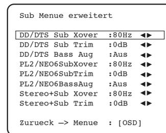
Für jede der drei Hauptbetriebsarten lassen sich nun drei unterschiedliche Trennfrequenzen und Pegelanpassungen (+/- 10dB) einstellen. DD/DTS-Dekodierung, PLII/Neo:6 Dekodierung und Betriebsart Stereo + Sub.
