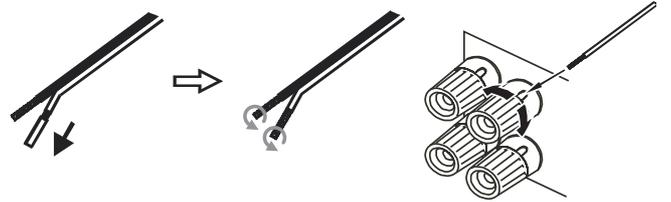
**Hinweis:** Alle Anschlüsse erfolgen über Lautsprecherkabel, außer bei Verwendung eines Aktivsubwoofers, der über ein Standard-Cinch-Audiokabel angeschlossen wird. Empfohlen werden an das Lautsprecherkabel angeschlossene Bananenstecker (4 mm) zum direkten Einstecken in die Lautsprecheranschlüsse.
