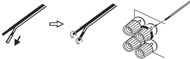
**Hinweis:** Alle Anschlüsse erfolgen über Boxenkabel, außer bei Verwendung eines Aktivsubwoofers, der über ein Standard-RCA-Phonokabel angeschlossen wird. Empfohlen werden an das Boxenkabel angeschlossene Bananenstecker (4 mm) zum direkten Einstecken in die Boxenanschlüsse.
