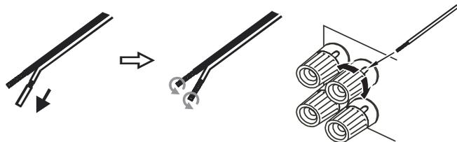
**Nota:** Tutte le connessioni sono realizzate tramite cavetti per diffusori, ad eccezione dell'eventuale subwoofer, da collegare per mezzo di un normale cavetto fono RCA. Per l'inserimento diretto nei terminali dei diffusori si consiglia l'impiego di spinotti a banana (standard da 4 mm).
