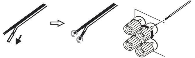
**Nota:** Todas las conexiones se realizan a través de cable de altavoz, salvo en el caso de que se utilice un subwoofer amplificado, que se conectaría a través de un cable RCA estándar. Se recomienda montar clavijas tipo banana (estándar de 4 mm) en los cables de los altavoces para conectarlas directamente a los terminales de los altavoces.
