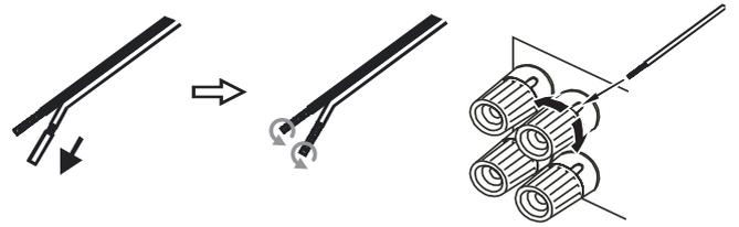
Il est recommandé d'utiliser des fiches bananes (4 mm standard) raccordées au câble d'enceinte pour l'insertion directe dans les bornes d'enceintes.
