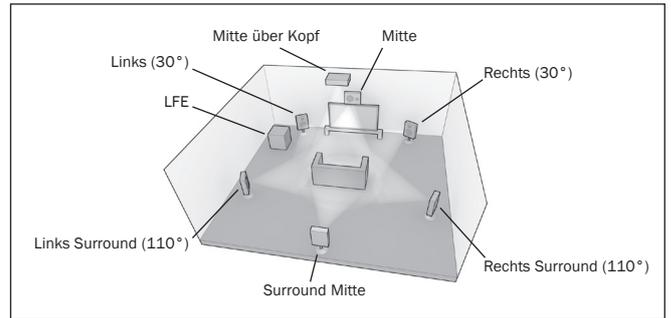
**Konfiguration 4** - 7.1-Kanal: L, C, R, LFE, Ls, Rs, Lh, Rh
