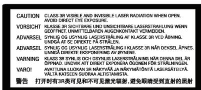
Diese Warnung befindet sich auf dem Schutzgehäuse des Lasers im inneren des Gerätes.
