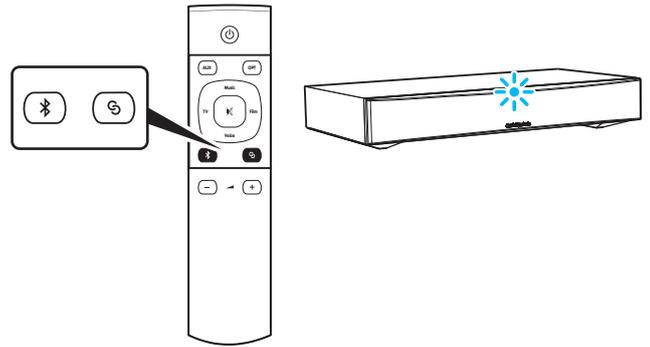
3. Для подключения к TV5 обратитесь к инструкциям вашего устройства Bluetooth. Успешное связывание будет подтверждаться звуковым сигналом устройства, и синий индикатор перестанет мигать.
