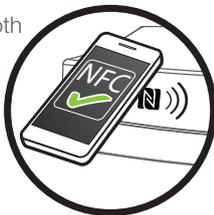
La réussite de l'association sera signalée par un « bip » de l'appareil et par la diode bleue
