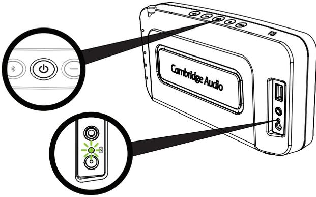
Enfoncez le bouton Marche
