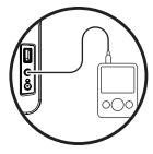
Pulse el botón QUX para seleccionar la entrada auxiliar.La unidad dispone de una entrada auxiliar en la parte posterior que permite conectar cualquier tipo de dispositivo analógico. El indicador LED se iluminará con una luz verde para indicar la selección de la entrada auxiliar.
