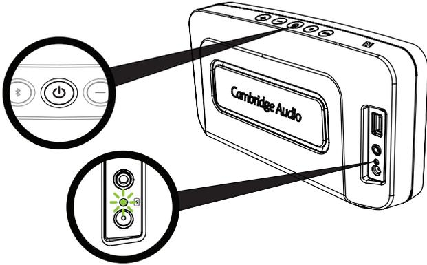
Enfoncez le bouton Marche
