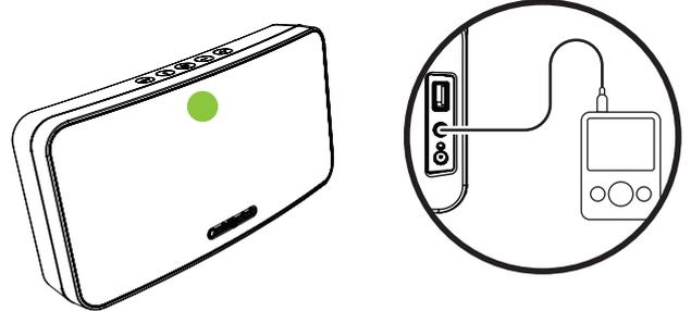
Appuyez sur le bouton **AUX** pour sélectionner l'entrée Aux. Il y a une entrée auxiliaire (Aux) sur l'arrière de l'unité qui permet de brancher un appareil analogique. La diode passe au vert pour indiquer que l'entrée Aux est sélectionnée.
