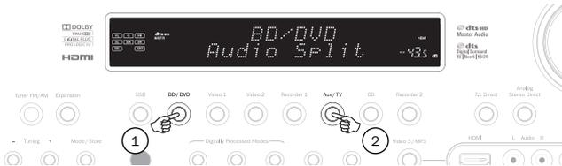
Der 651R/751R ermöglicht ein Splitting von jeder Quelle, ungeachtet ihrer Videoeingangsart (Composite, S-Video, Component oder HDMI). Dies gilt aber nur für Quellen, bei denen Analog Audio oder Digital Audio, und nicht HDMI, als die aktuelle Audioeingangsart eingestellt ist.
