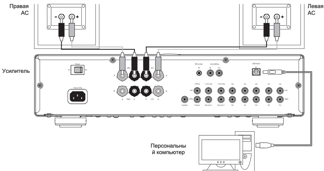
**Примечание.** Для подключения аудиоустройств всегда используйте сертифицированный USB-кабель, предпочтительно с официальной маркировкой. При использовании USB-кабеля длиной более 3 метров возможно нестабильное воспроизведение звука.
