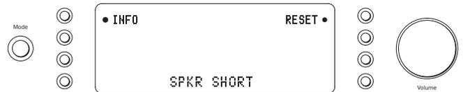
**Descrizione** - Durante l'accensione in modalità Standby il CAP5 esegue una verifica dei terminali degli altoparlanti per vedere se sia stato accidentalmente introdotto un cortocircuito (sul display lampeggia la dicitura "SPKR CHECK"). Se la resistenza misurata attraverso i terminali degli altoparlanti è troppo bassa, l'apparecchio resta in modalità Standby fino alla rimozione del malfunzionamento dopo di che prova a riaccendersi (sul display lampeggia la dicitura "SPKR SHORT").
