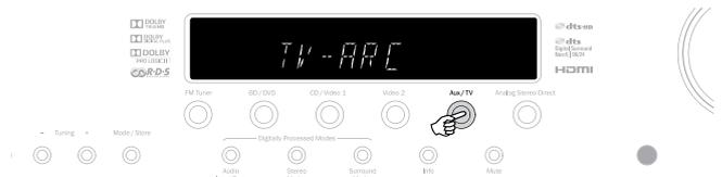
**Hinweis:** Bei vielen Fernsehgeräten muss die CED/HDMI-Verbindung (die häufig anders genannt wird, z.B. Verialink oder AnyNet) aktiviert sein, damit ARC funktioniert
