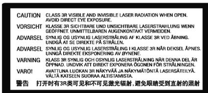
Dieser Aufkleber befindet sich im Inneren des Geräts auf dem Schutzgehäuse des Lasers.
