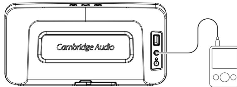
**1** Sul retro dell'unità si trova un ingresso Aux che consente la connessione di qualsiasi dispositivo analogico. Per ascoltare un ingresso Aux, accertarsi che la riproduzione da qualsiasi dispositivo Bluetooth accoppiato sia in pausa. Quando non si riproduce alcun audio Bluetooth, il Minx Go riprodurrà automaticamente l'ingresso Aux.
