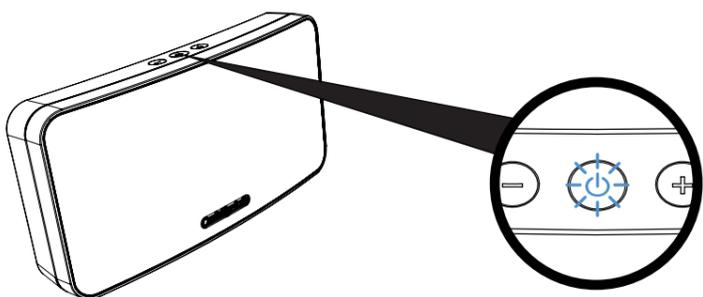
**2** Abilitate la connettività Bluetooth sul vostro dispositivo Bluetooth (ad es., telefono, tablet, ecc.) e abbinatelo con il Minx Go (potreste dover consultare le istruzioni di funzionamento del vostro telefono o tablet). Se l'accoppiamento va a buon fine sarà indicato da un 'beep' proveniente dall'unità e dal LED di alimentazione blu fisso.
