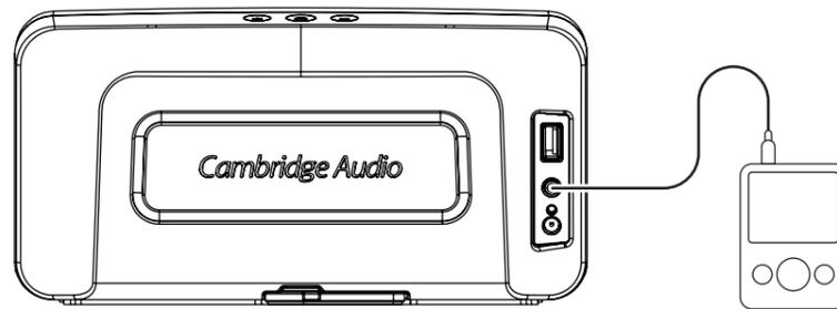
1 Une entrée auxiliaire (Aux) à l'arrière de l'unité permet de brancher un appareil analogique. Pour écouter le son cette entrée auxiliaire, la lecture venant d'un éventuel appareil Bluetooth associé devra être mise en pause. Si aucune entrée Bluetooth n'est lue, votre Minx Go lira automatiquement l'entrée auxiliaire.
