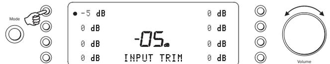
Il est possible d'ajuster les niveaux relatifs des entrées grâce à la compensation de gain. Cela permet de régler les entrées de sorte que chacune produise le même son en termes d'intensité lorsque vous passez d'une entrée à une autre ou à d'autres options. Choisissez la source sonore la plus intense et ajustez son niveau jusqu'à ce qu'il atteigne le niveau perçu moyen des autres. Répétez ce processus si d'autres sources se distinguent également par un son plus fort que la moyenne.
