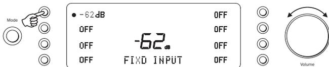
Sélectionnez l'entrée requise et réglez le gain fixe à l'aide de la commande du volume (le réglage désactivé (OFF) ne désactive pas l'entrée mais le gain d'entrée sera réglable par la commande du volume, qui est le réglage par défaut). Lorsqu'une entrée fixe est attribuée à une source, la balance est toujours réglée sur neutre. Appuyez sur le bouton Mode pour quitter.
