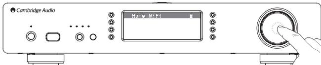
Lorsque l'ESSID du réseau sans fil auquel vous souhaitez vous connecter s'affiche à l'écran, appuyez sur le bouton de sélection (SELECT). Si votre réseau n'est pas configuré avec une clé de chiffrement, l'écran doit afficher « Connexion au réseau » (Connecting to network), puis « Réseau OK » (Network OK).
