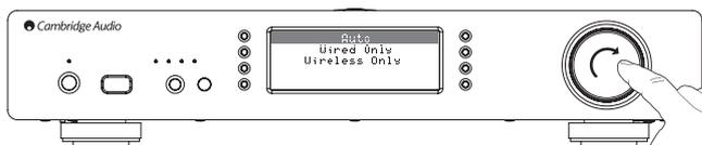
Si vous sélectionnez « Filaire uniquement », le Stream Magic 6 redémarrera et utilisera par la suite uniquement sa connexion Ethernet pour communiquer avec le réseau. Si vous sélectionnez « Sans fil uniquement », le Stream Magic 6 redémarrera et utilisera uniquement sa connexion Wi-Fi. Si vous sélectionnez « Auto », le Stream Magic 6 essaiera de se connecter des deux manières et conservera celle par laquelle il parvient à se connecter comme décrit ci-dessus.
