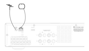
**Hinweis:** Im Lieferumfang des SR10 ist eine Behelfsantenne enthalten. Wir empfehlen Ihnen, für einen dauerhaften Gebrauch eine Außenantenne zu verwenden.
