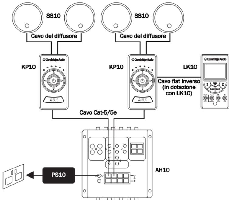
**Importante:** Il modello LK10 funziona solo quando collegato al dispositivo KP10 in quanto parti di un sistema hub-based AH10. Nessuna compatibilità con amplificatori "Incognito Ready".
