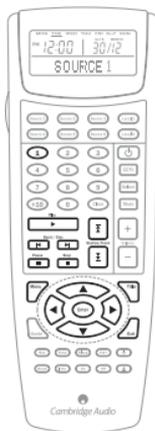
Per ricevere i comando, LK10 dovrà essere impostata su modalità Learn. LK10 ha una serie di menu a cui è possibile accedere premendo il pulsante Shift/Set sul pannello anteriore. Si scorrono continuamente le opzioni del menu sul display LK10, fino a quando non si rilascia il pulsante *Shift/Set*.
