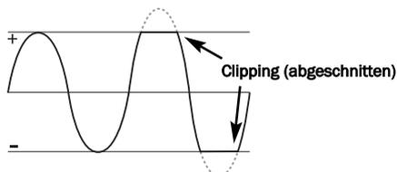
Falls der 840W Clipping erkennt, blinkt diese LED kurz auf. Falls das Clipping ein Ausmaß erreicht, dass den Verstärker oder die angeschlossenen Lautsprecher beschädigen könnte, schaltet das Gerät eine Schutzschaltung ein.
