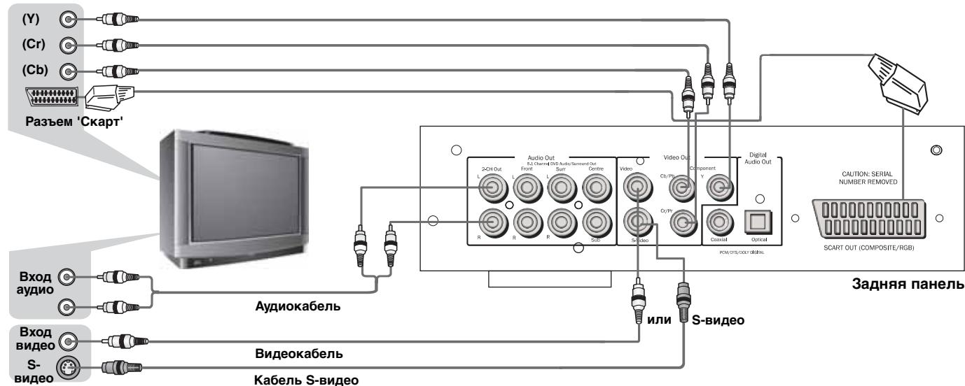
Плееры DVD85 и 89 имеют широкий набор видеовыходов. Вам следует всегда использовать подключение наивысшего качества, поддерживаемое вашим телевизором . Для улучшения качества Вам следует использовать один из разъемов: композитный (CVBS), S-видео, RGB Scart, компонентное видео (YUV), DVI и, наконец, HDMI.
