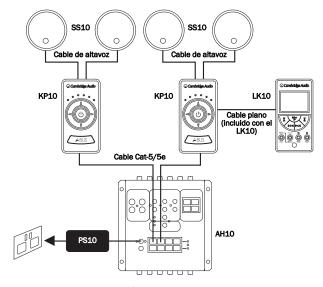
**Importante**: el LK10 solo funcionará al conectarlo al KP10 como parte de un sistema completo AH10 basado en un concentrador. No es compatible con amplificadores 'Incognito Ready'.
