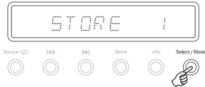
2. Ruotare il *controllo del volume* sul pannello anteriore dell'unità oppure premere il controllo del volume sul telecomando per passare ad un nuovo numero di preset quindi premere *Select* per memorizzare il preset. Il display mostrerà brevemente che la stazione è stata memorizzata.
