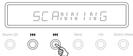
3. Premere brevemente una sola volta il pulsante **⏮** o **⏭** per sintonizzare al meglio la frequenza della stazione.
