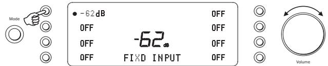
Seleccione la entrada requerida y establezca la ganancia fija utilizando el control de volumen (el ajuste OFF no desactiva la entrada, sino que deja la ganancia de entrada a merced del control de volumen que tenga el ajuste predefinido). Cuando una fuente tiene una entrada fija, el balance siempre se ajusta a neutro. Pulse el botón Mode para salir.
