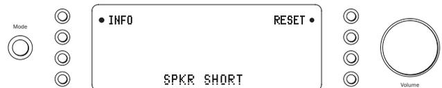
**Descripción** - Durante el encendido a partir de Standby, CAP5 realiza un chequeo de los terminales de los altavoces para ver si hay algún cortocircuito accidental en los mismos (la pantalla parpadea "SPKR CHECK"). Si la resistencia medida entre los terminales de los altavoces es demasiado baja, el equipo permanecerá en el modo Standby hasta que se solucione el fallo y se vuelva a reintentar el encendido (la pantalla parpadea "SPKR SHORT").
