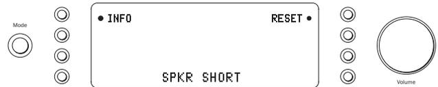
**Beschreibung** - Beim Einschalten nach Standby überprüft CAP5 die Lautsprecheranschlüsse auf einen versehentlich ausgelösten Kurzschluss (auf dem Display blinkt "SPKR CHECK"). Wenn der gemessene Gesamtwiderstand an den Lautsprecheranschlüssen zu niedrig ist, wird der Verstärker im Standby-Modus erst eingeschaltet, wenn der Fehler behoben wurde und ein erneutes Einschalten versucht wird (auf dem Display blinkt "SPKR SHORT").
