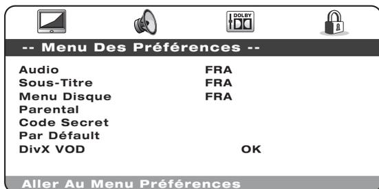
Les menus de préférence sont utilisés pour configurer la langue par défaut que les pistes du 540D V2 utiliseront pour les pistes son, sous-titres et menu du disque s'ils sont disponibles sur le disque. Le 540D V2 sélectionnera automatiquement la langue appropriée parmi celles disponibles sur le disque quand cela est possible.
