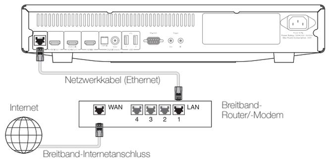
Schließen Sie das eine Ende des Kabels (Ethernet-Kabel Typ 5/6E ungekreuzt) an den LAN-Anschluss auf der Rückseite des Gerätes an. Verbinden Sie das andere Ende des Netzwerkkabels mit einem freien Anschluss an Ihrem Breitband-Router oder Modem.
