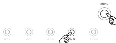
Maintenez simultanément les boutons 4/9 et Menu enfoncés. L'afficheur indiquera la révision logicielle suivie d'une lettre « A » pour Amérique du Nord ou d'une lettre « E » pour l'Europe/le reste du monde. Redémarrez l'appareil en l'éteignant, puis en le mettant en marche.
