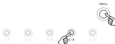
Halten Sie die Tasten „4/9“ und „Menu“ gleichzeitig gedrückt. Auf dem Display wird die Software-Version angezeigt, gefolgt entweder vom Buchstaben „A“ (Nordamerika) oder „E“ (Europa bzw. die übrige Welt). Schaltet Sie dann das Gerät aus und wieder ein.
